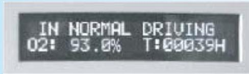
運転中の酸素ガス純度、積算運転時間を監視してLCD(表示器)に表示し、純度異常やコンプレッサー
